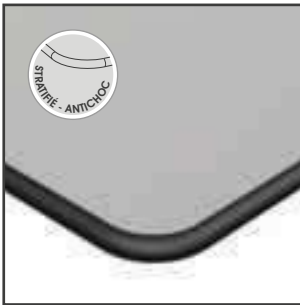
Panneau allégé contreplaqué stratifié p.20 mm chant PVC antichoc coloris noir, contrebalancement coloris blanc.
