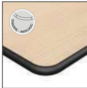
Panneau de particules stratifié p.24 mm chant PVC antichoc coloris noir, contrebalancement coloris blanc.
